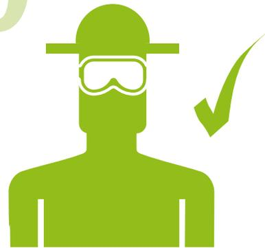
Para máquinas y equipos que generan proyección de partículas y/o chispas, utilice anteojos o gafas de seguridad y también pantallas que evite el contacto con compañeros de trabajo.
