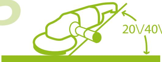
Utilice la herramienta sin ejercer fuerza desmedida. Para el esmeril considere un ángulo de corte  $90^\circ$  y entre  $20^\circ$  a  $40^\circ$  para pulido o desbaste.
