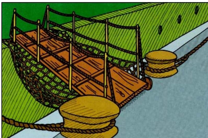
Figura 3. La pasarela debe estar firmemente trincada al costado del barco y con una red de seguridad para prevenir caídas al agua.
