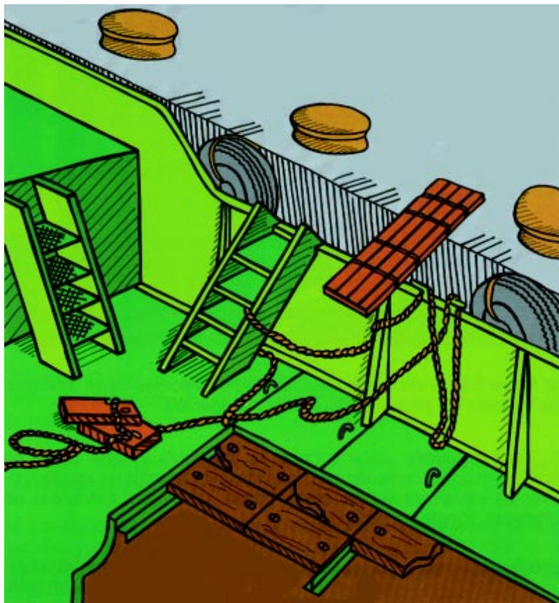
Figura 6. Pasarela y escala de amurada sin barandas, cabos sin adujar, cubiertas sin aclarar, cuarteles rotos, etc., causan graves accidentes de a bordo.
