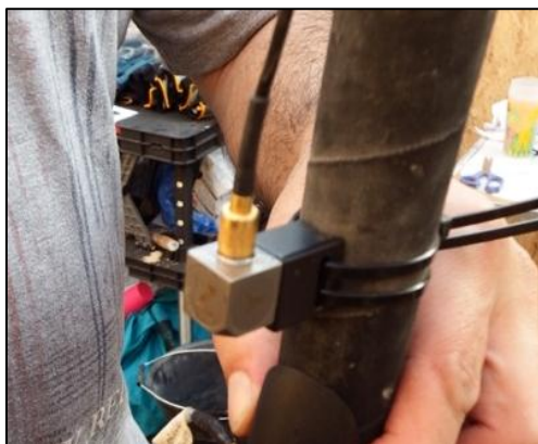
Figura 17.- Acelerómetro y acoplador unido directamente a la herramienta.
