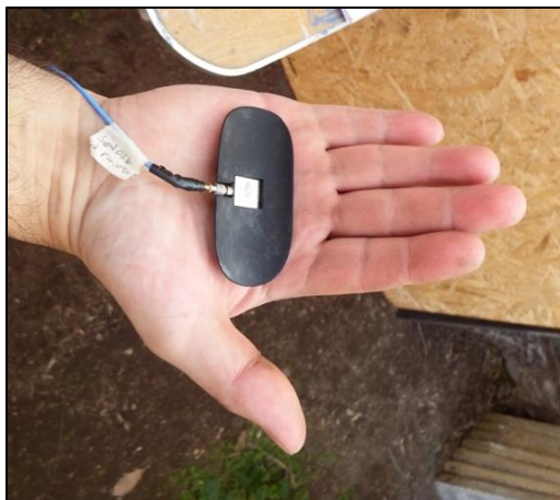
Figura 16.- Acelerómetro y acoplador en la palma de la mano
