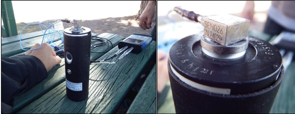
Figura 18 .- Verificación de la cadena instrumental y ganancia de entrada, utilizando una fuente de vibración de referencia.
