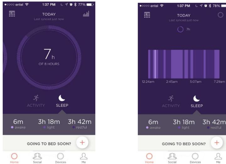
Según información del fabricante, la información de sueño y actividad se obtiene y calcula a partir de datos de su acelerómetro y magnetómetro triaxial.
