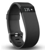
Este dispositivo recopila información del usuario por medio de los sensores: monitor óptico del ritmo cardíaco, acelerómetro triaxial y altímetro. Tiene un pequeño visor para ver la hora, frecuencia cardiaca y otros indicadores.
