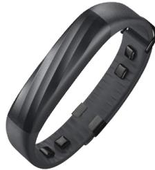
Este dispositivo recopila información del usuario por medio de sensores de bioimpedancia, piel y temperatura ambiente, junto con un acelerómetro triaxial. No tiene visor, toda la información se obtiene a través de una aplicación móvil.
