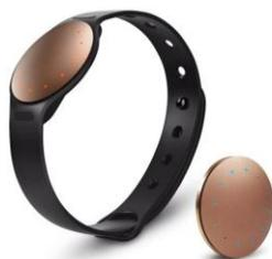
En el periodo de evaluación se utilizó el dispositivo en la muñeca. Este dispositivo recopila información del usuario por medio de un acelerómetro triaxial y un magnetómetro triaxial. No tiene visor, sin embargo permite ver la hora y cumplimiento de metas por medio de los puntos luminosos en su borde.
