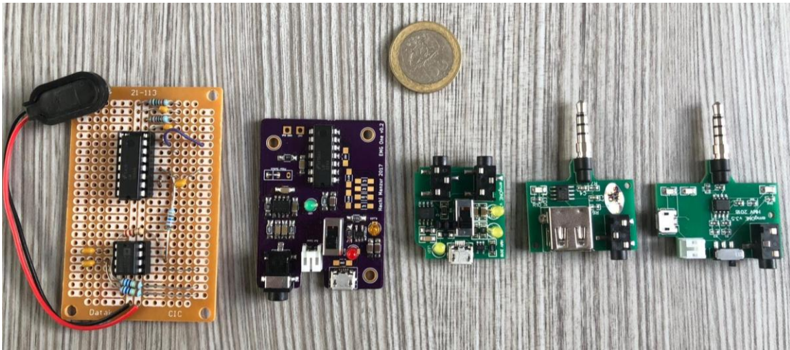
Figura 3. Evolución de las distintas versiones de hardware, desde el primer prototipo hasta la versión final.
