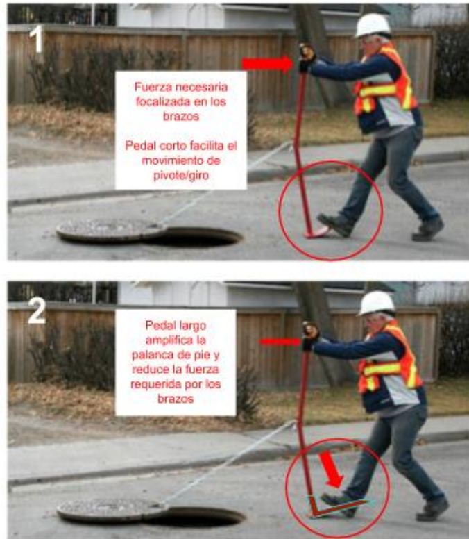
Ejemplo de uso de Camlift Tool (1) y ejemplo de ajuste propuesto para palanca de pie (2)
