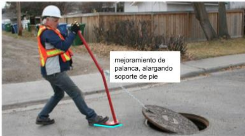
Herramienta "Camlift Tool". Fuente: http://camlifttool.com/index.html
