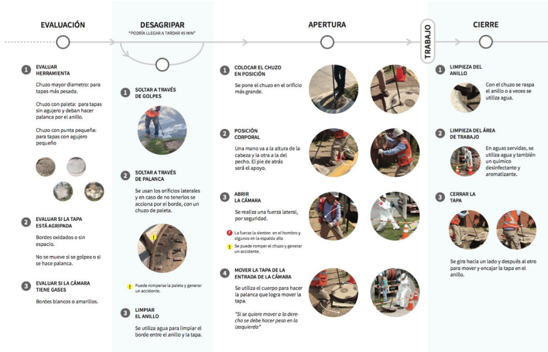
Secuencia de apertura de tapas de cámara de registro
