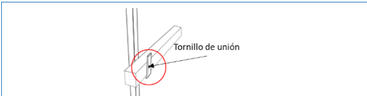
Figura 7: Esquema unión perfil vertical con largueros horizontales y la distancia de traslape – Elaboración Propia
