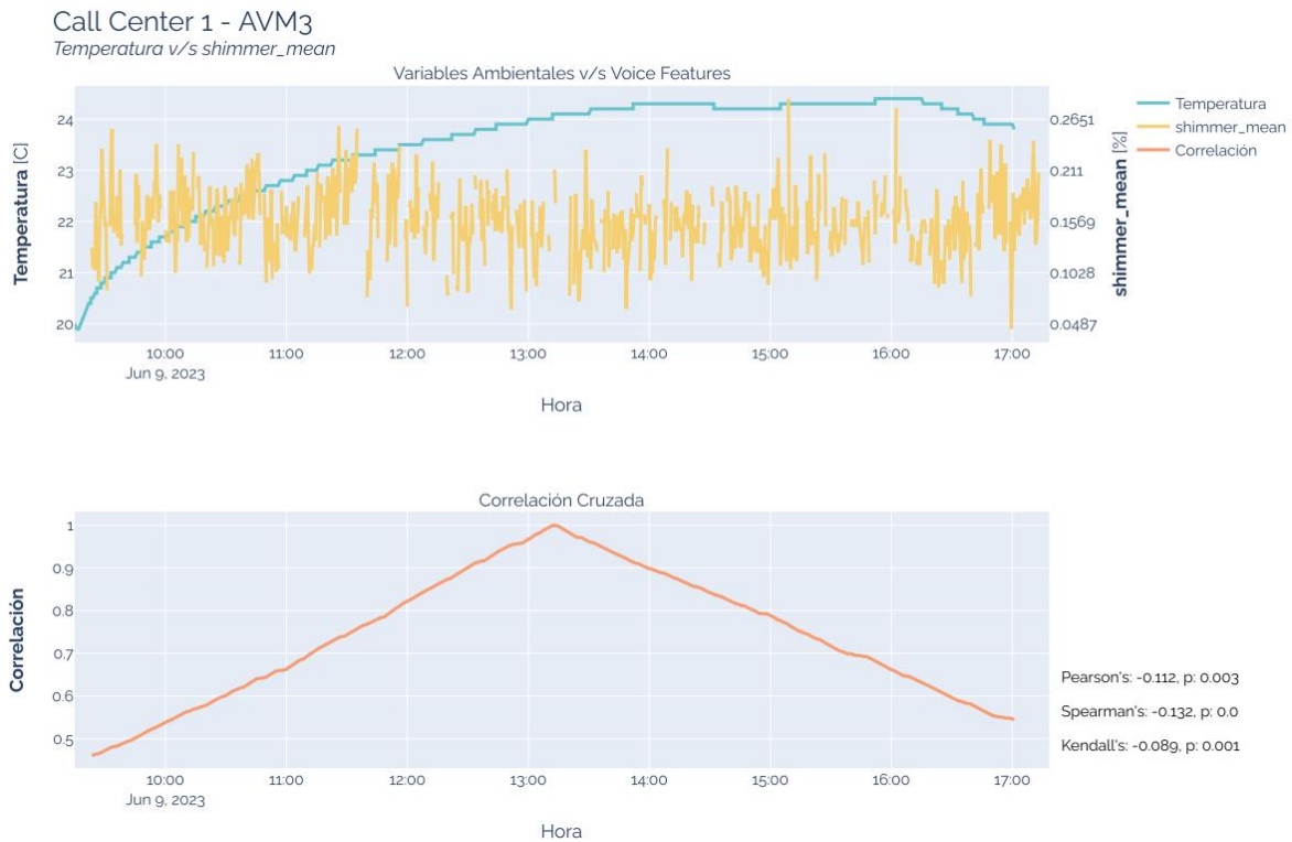
Figura 22. Figura de ejemplo de los resultados obtenidos. Arriba. Se observa gráfico con parámetro shimmer durante todo el tiempo de grabación, temperatura ambiental medida en el Call center durante todo el tiempo de grabación. Abajo. Se observa gráfico que indica nivel de correlación cruzada normalizada y resultados de medidas de asociación, con foco en Coeficiente de Spearman.
