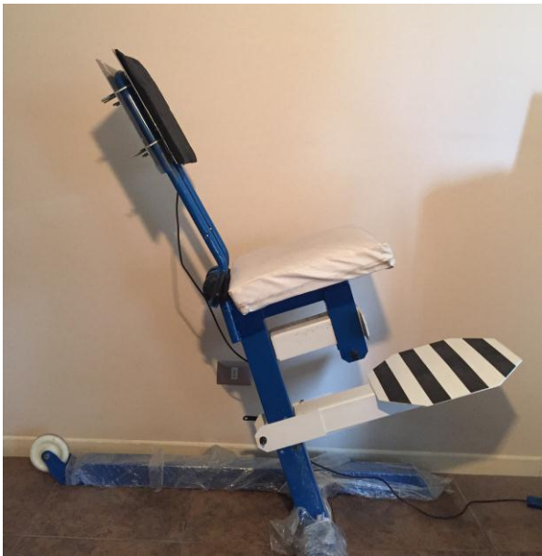
Figura 2. Vista lateral de silla instrumentada con célula de carga AMTI en respaldo.
